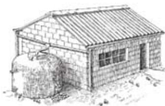
Exemple d'une technologie améliorée d'approvisionnement en eau potable: récolte d'eau de pluie.
